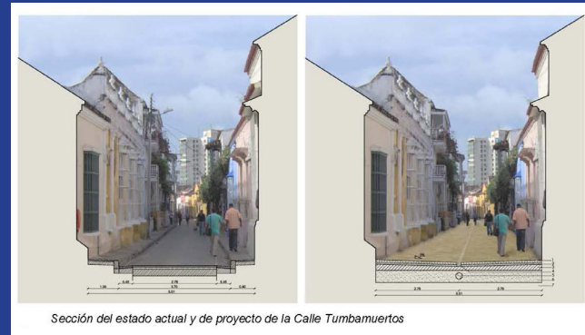
Sección del estado actual y de proyecto de la Calle Tumbamuertos Prototype multipurpose street horizontal profile proposed for the Historic Center of Cartagena
